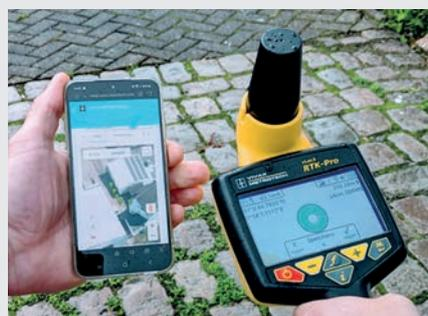
Messpunkte auf Smartphone einsehbar
